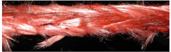
Bild 1: Beispiel Fransenbildung [ Jakob AG / Uni Stuttgart ]
