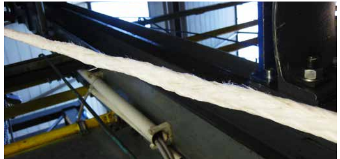
Bild 2: Beispiel Welligkeit [ Jakob AG / Uni Stuttgart ]
