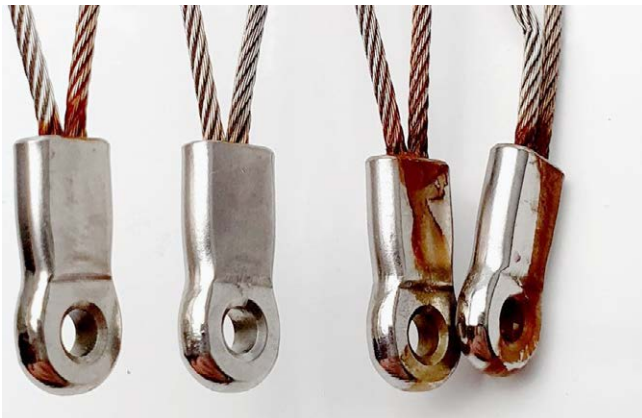
Abbildung 1: Beispielbild der Oberflächenkorrosion am unteren Netzrand im Laborversuch [Quelle: K-Labor].
